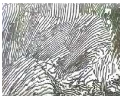
شکل ۴-۱: فولاد پرلیت 0.9% کربن در مقیاس هزار برابر
